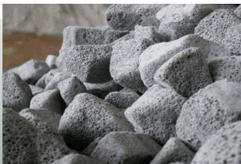
All'elevata temperatura a cui è sottoposto, il vetro «schiuma» ed in uscita dal forno si presenta sotto forma di vetro cellulare. A contatto con l'aria, la vetroschiuma si rompe autonomamente in pezzatura centimetrica, racchiudendo al suo interno un'enorme quantità di aria, che gli conferisce un ottimo grado isolante con conseguente elevato comfort termico, nonché un peso specifico a cumulo molto basso.
