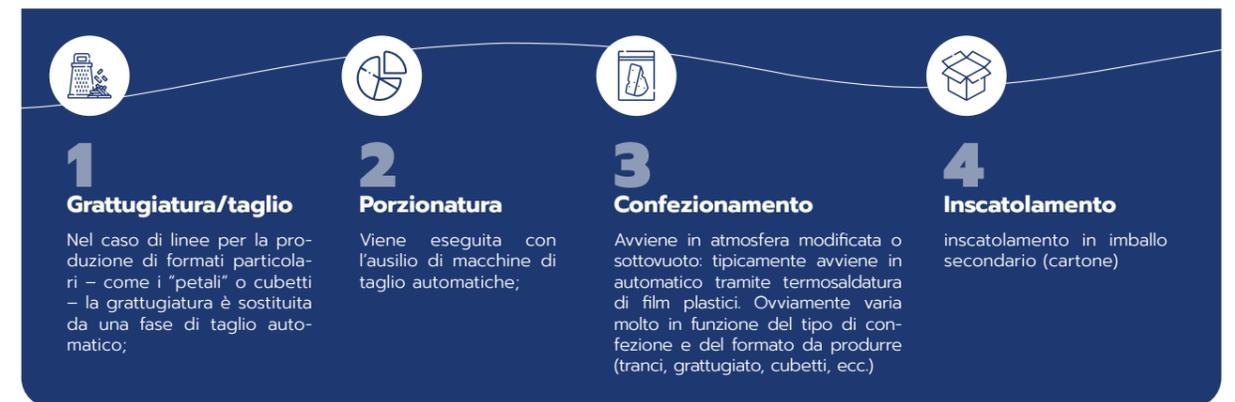
Su tutte le linee la movimentazione del materiale viene effettuata tramite nastri trasportatori e nastri elevatori. Gli operatori sono occupati nella conduzione e regolazione generale del funzionamento della linea e delle relative attrezzature e, dove non ancora automatizzata, nella fase di inscatolamento finale delle confezioni.
