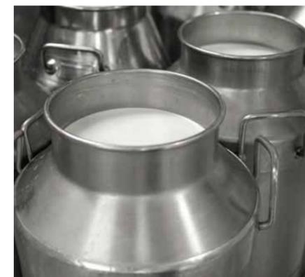
Il latte della mungitura serale arriva al caseificio e viene lasciato a riposare fino al mattino in apposite vasche d'acciaio a temperatura controllata: durante la notte avviene il processo di affioramento della panna, che sarà poi destinata alla produzione di burro, mentre il latte scremato viene miscelato insieme al latte intero della mungitura del mattino.
